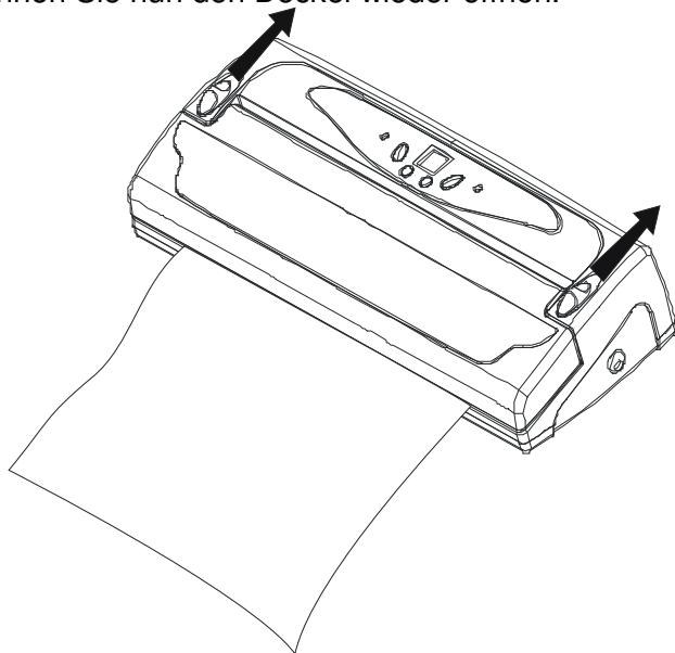
4. Befüllen Sie nun den Beutel mit dem Vakuumiergut und legen Sie diesen mit der Öffnung wie unter 2. abgebildet über den Schweißbalken. Die Kante des Beutels sollte muß in der Vakuumierzelle des Gerätes liegen.
