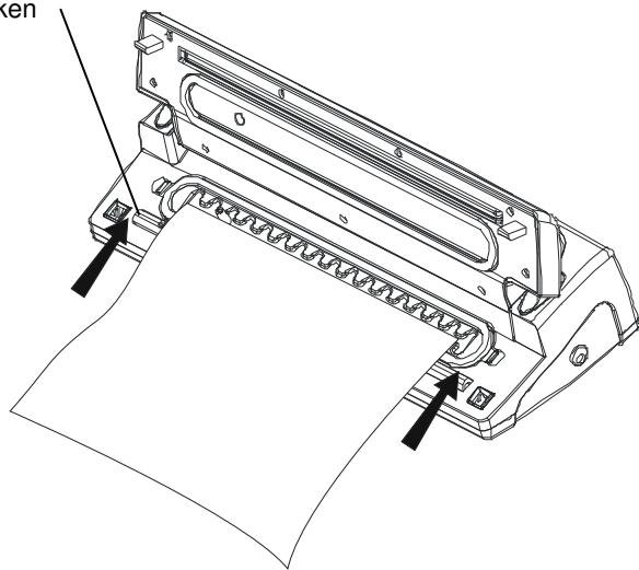
3. Durch gleichzeitiges Betätigen der beiden Entsperr-Knöpfe zum Aufheben der Verriegelung können Sie nun den Deckel wieder öffnen.
