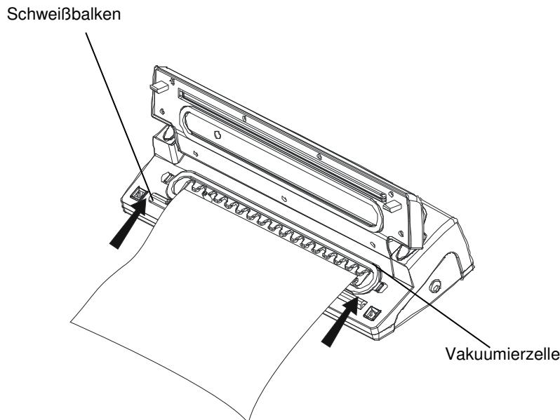
5. Drücken Sie nun wie zuvor die Abdeckung herunter bis Sie einrastet und betätigen Sie anschließend den Schalter „Vacuum“. Der Vakuumiervorgang startet nun. Er endet automatisch mit dem anschließenden Schweißvorgang. Durch erneutes Betätigen der Endsperrknöpfe können Sie den Deckel wieder öffnen und den nun fertig verschweißten Beutel entnehmen.
