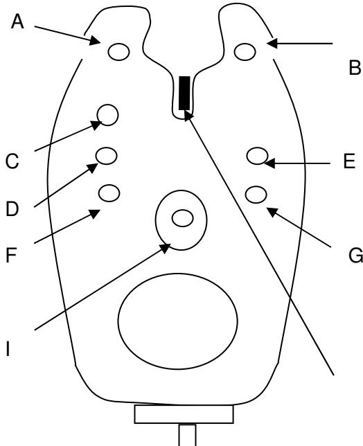
A= Leuchtdiode mit Nachleuchtfunktion. Diese Diode leuchtet 20 Sekunden nach der Aktion am Bißanzeiger
