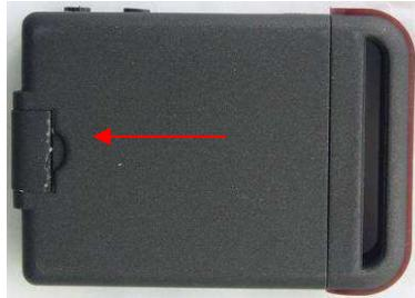
2. Drücken Sie die Metall-Schutzhülle des SIM-Kartenfachs nach rechts um sie zu entsichern und klappen Sie diese anschließend wie in der Abbildung beschrieben auf.
