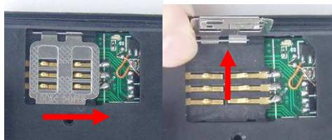
3. Legen Sie die SIM-Karte in die Halterung und verschließen Sie die Metall-Schutzhülle wieder.
