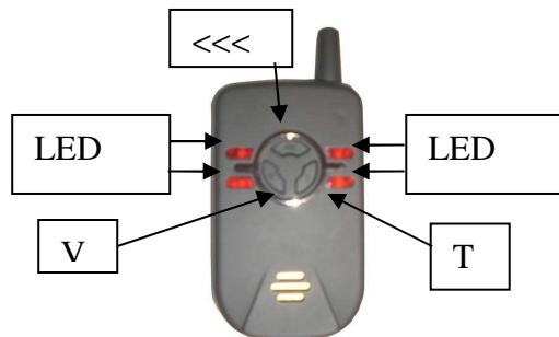
Die Sounderbox wurde Werkseitig mit 4 LED ausgestattet. Jede LED dient zur optischen Anzeige eines Bissanzeigers. (Dieses Bissanzeiger Set besteht allerdings aus 3 Bissanzeigern mit Sounderbox und kann nicht auf 4 Bissanzeiger erweitert werden.)
