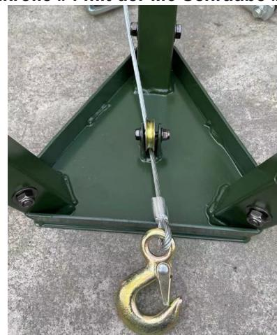
**Schritt 3:** Verbinden Sie das Stahlseil mit der Seilwinde und spulen Sie dieses auf. Montieren Sie die Seilwinde F nach innen an der Mittelstreb e für die Windenbefestigung C und befestigen Sie diese mit den M10 Schrauben #2.
